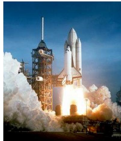
La misión de poner en órbita un Transbordador no es tarea fácil. Este vehículo de 3 billones de dólares, mide 37,2 mts de largo y puede soportar una carga máxima de 29,5 toneladas basado en un sistema de cohetes propulsores y tanque principal de combustible (Oxígeno líquido e Hidrógeno líquido). Su lanzamiento es una operación complicada, pero luego de 8,5 minutos de haber despegado, esta nave logra escapar de la gravedad terrestre y situarse en órbita sobre nuestro planeta.
